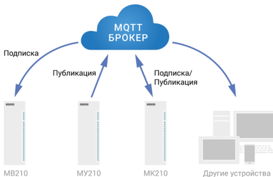
Рисунок 6.5 – Структурная схема обмена по протоколу MQTT
