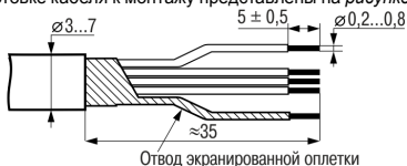
Рисунок 5 – Подготовка кабеля
